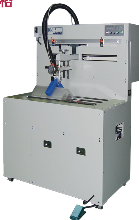
除電・除塵が終わると45°旋回し、金属探知機へ
