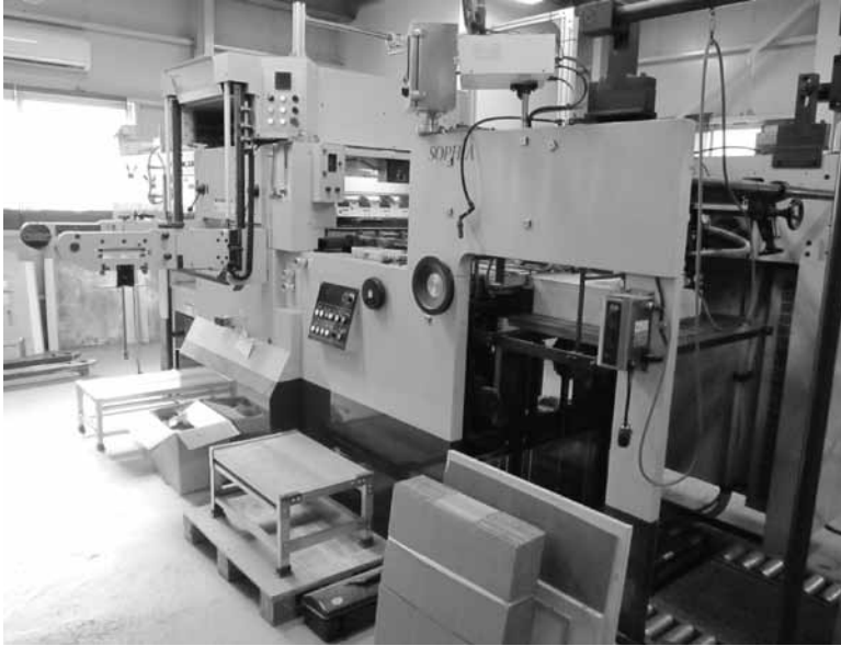
▲工場1階に設置された自動平盤打抜機
